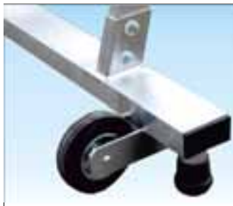
Basetta posteriore AUTO-FRENANTE con ruote per il trasporto a carriola Realizzata in alluminio è smontabile per il trasporto ed utilizza ruote in gomma nera Ø 125 mm. e tamponi a terra che frenano la scala automaticamente
