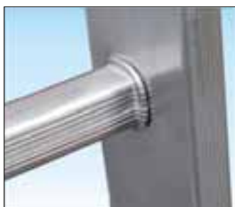
Piolo quadro mm. 30 x 30 anti-scivolo molto robusto con doppia bordatura Unione tra piolo e montante con doppia bordatura, interna ed esterna, per la massima solidità contro urti accidentali ed una lunga durata nel tempo
