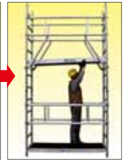
Installa la piattaforma superiore all'ultimo piolo e sali attraverso la botola
