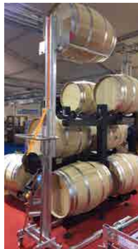
HW 270 S con HW.FR, Forche regolabili per prelievo e posizionamento barriques. HW 270 S with HW.FR, Adjustable forks to pick up and position barriques.
