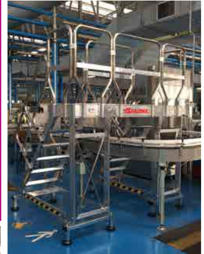
Configurazione scala a ponte a Z con battitacco laterale e base fissa. Z-shaped ladder configuration with side sill and fixed base.
