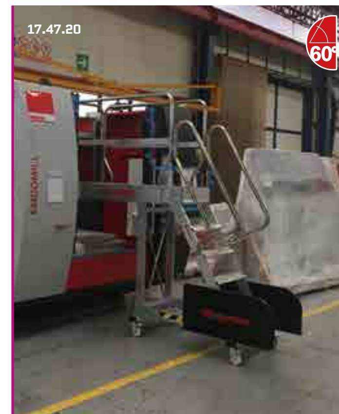
Scala a sbalzo frontale con base compatta. Front cantilever staircase with compact base.
