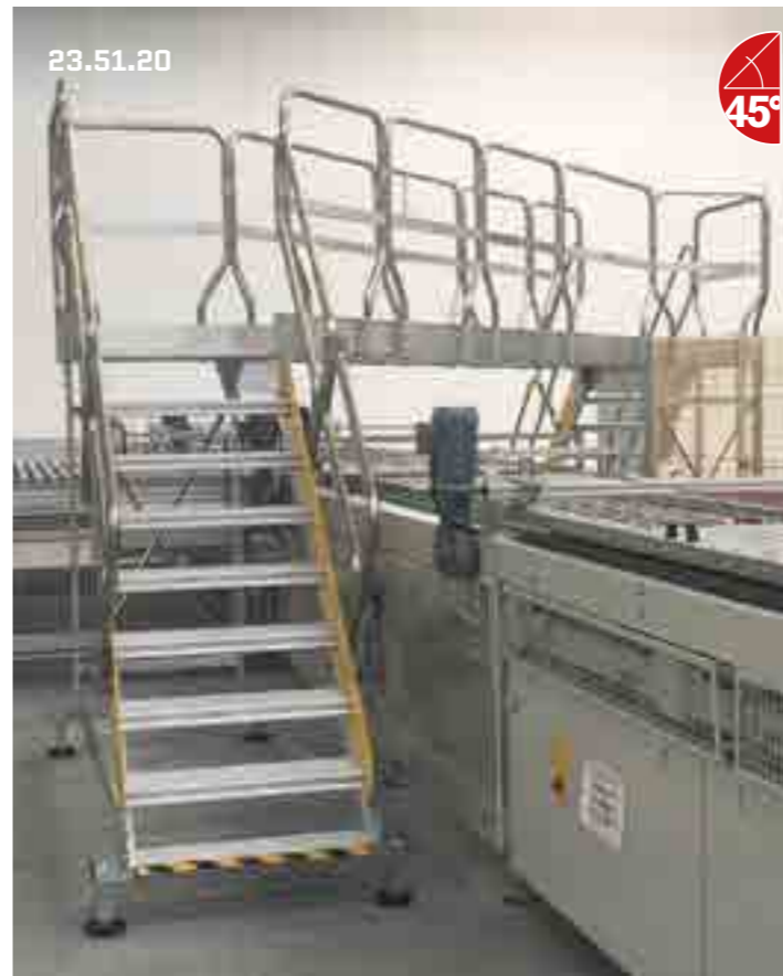
Configurazione scala a ponte a Z con battitacco laterale e base fissa. Z-shaped ladder configuration with side sill and fixed base.
