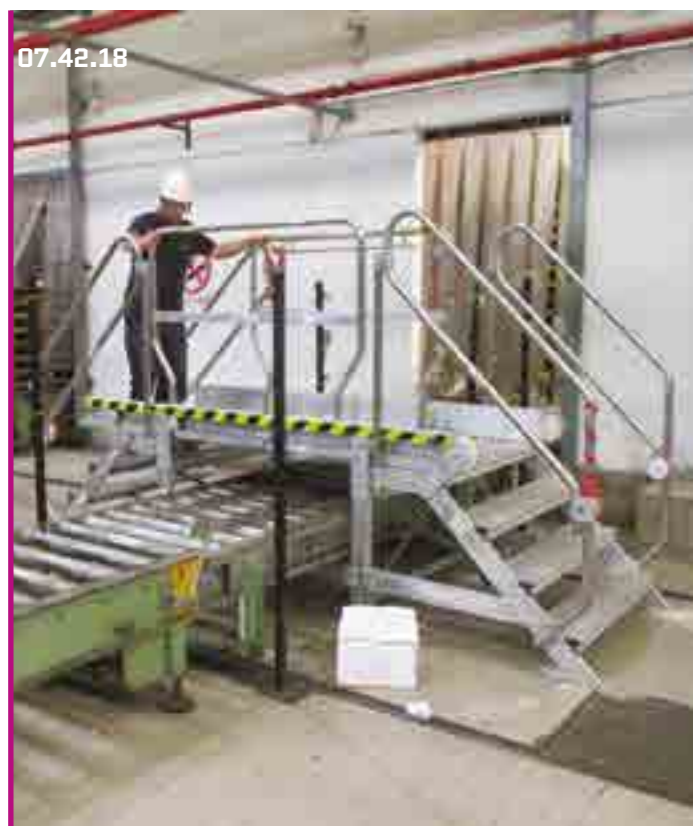
Scala a ponte retrattile per attraversamento linee di produzione. Retractable crossover ladder for crossing production lines.
