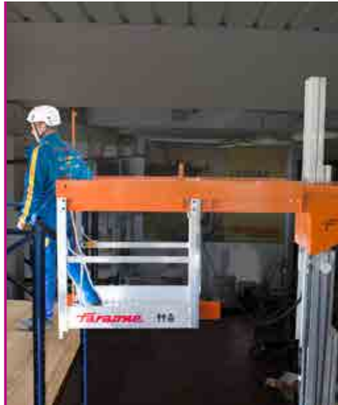
Piattaforma Elevah per lo sbarco in quota per 1 operatore. Elevah platform for exit at height for 1 operator.
